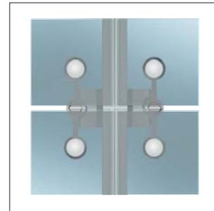
Sistema de fachada ligera de vidrio exterior anclado mediante grampones y piezas de fijación: rótulas o fijas. Los grampones están fabricados en acero inoxidable y abrazan las rótulas sobre las que posteriormente se fijará el vidrio, previamente troquelado para permitir dicha fijación.
